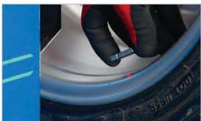
Un punto laser indica la posizione dei pesi adesivi sulla ruota in modo semplice, rapido e preciso. Poiché la posizione dei pesi viene indicata alla base del cerchione, l'operatore può posizionare ergonomicamente i pesi rapidamente e senza errori.
