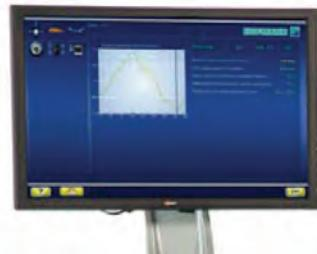
La diagnosi di eccentricità della ruota viene eseguita durante la misurazione dello squilibrio per non compromettere la produttività. L'eccentricità viene rilevata automaticamente durante la diagnosi del cerchione, fornendo indicazioni per il matching geometrico al fine di eliminare le vibrazioni causate da deformazioni geometriche.
