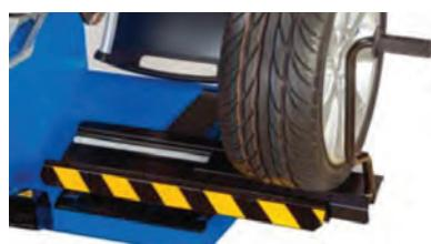
Un sollevatore ruota innovativo che permette di sollevare in modo rapido e semplice ruote fino a un peso di 70 kg. La ruota viene sollevata automaticamente fino all'altezza dell'ultimo centrallino e dopo il bloccaggio la piattaforma torna automaticamente in posizione di riposo, riducendo in tal modo la durata del ciclo totale.
