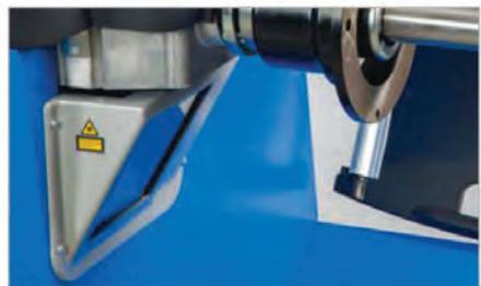
Lo scanner cerchione rileva automaticamente la distanza e il diametro del cerchione, come pure il numero e la posizione delle razze. Seleziona quindi automaticamente la modalità di equilibratura, nonché la tipologia e la posizione dei pesi. Di questa funzionalità e del rilevamento automatico della larghezza cerchione tramite Smart Sonar risulta una combinazione ideale di accuratezza e produttività elevate.
