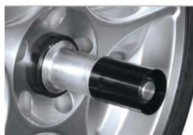
Sistema Power Clamp™ consente un rapido bloccaggio e sbloccaggio delle ruote.
